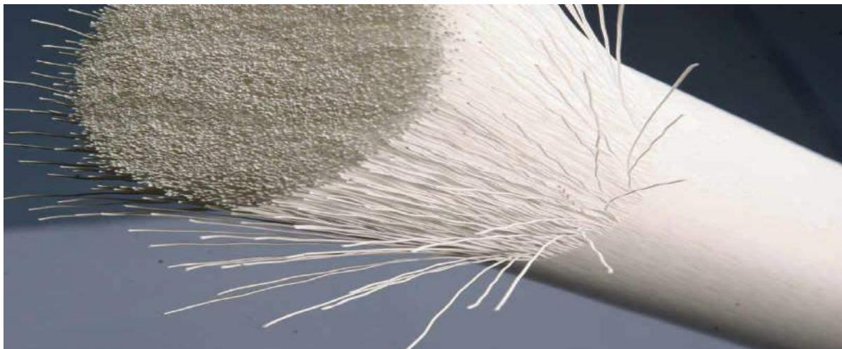
Şekil 2. Hallow-Fiber Membran Görünümü
