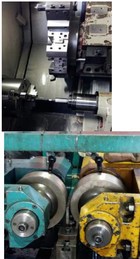
**Şekil 2.** (a) Talaşlı Üretim CNC Torna Tezgahı (b) İki Roleli Ovalama Tezgahı
