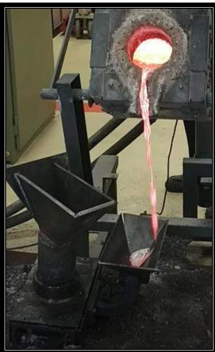
**Şekil 1-Alüminyum Döküm İşlemi**
