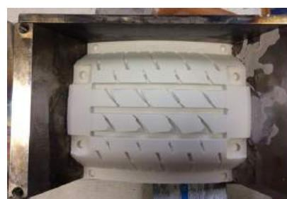
Şekil 7-Prototip Üretim İçin Alçı Model Yapımı
