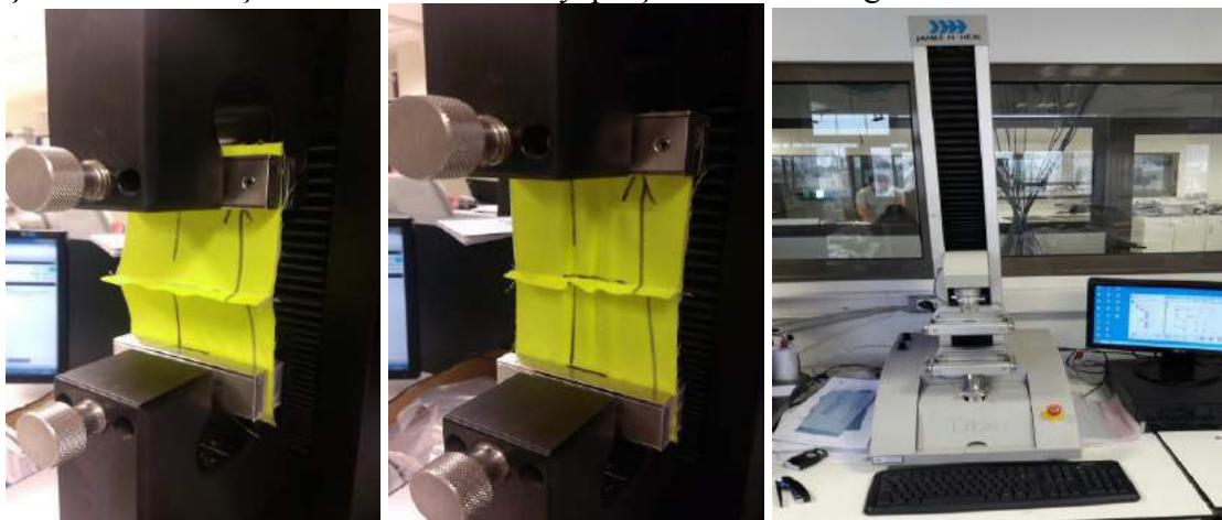
Şekil 3.4. Dikiş mukavemeti testinin uygulanışı ve test cihazı.
