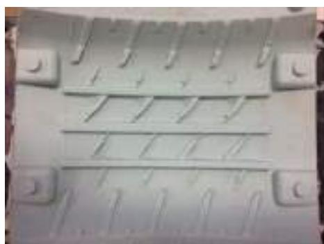
Şekil 6-Prototip Üretim İçin Silikon Model Yapımı
